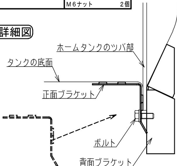
1. 正面、背面アダプタに接地ブラケットをボルト、ナット止めします。
