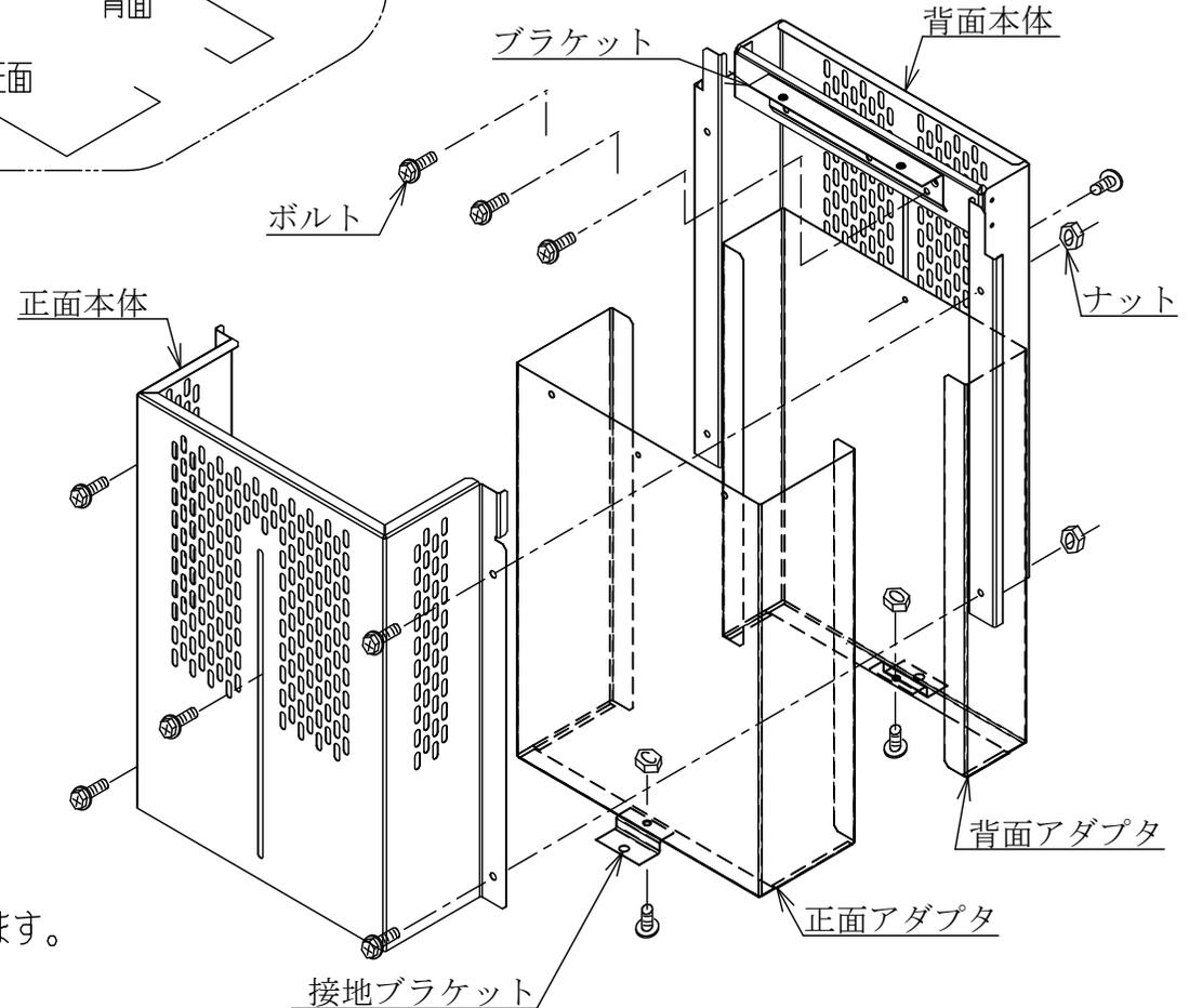
1. 正面、背面アダプタに接地ブラケットをボルト、ナット止めします。
